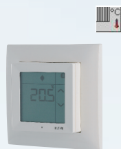
RF pokojový termostat s dotykovým displejem 55x55 mm pro topení a chlazení, senzor teploty, vlhkosti a intenzity, externí senzor PT1000, dvě dotyková tlačítka
